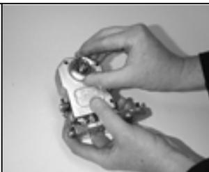
**S** Smörj locket med fett och montera det med de tre skruvarna.
