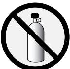
**Keine Gas- oder Druckluftflaschen verwenden!**
